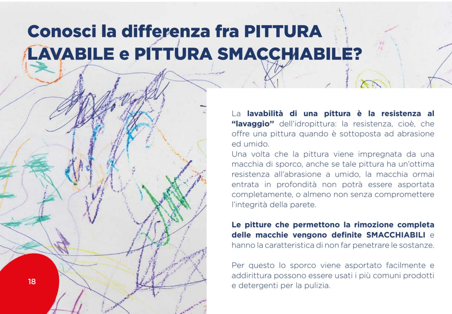
La **lavabilità di una pittura è la resistenza al "lavaggio"** dell'idropittura: la resistenza, cioè, che offre una pittura quando è sottoposta ad abrasione ed umido.
